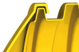
Montaż pokrywy skrajnej na zakładkę
